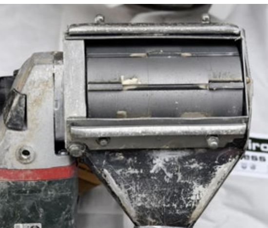
Staubreduziert: Dieser Fräskopf trägt die Schicht in groben Körnern ab.
